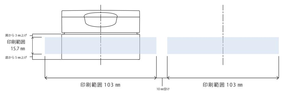
Cocon-80 ヒンジ CAP 印刷範囲 ※本図面はシルク印刷における最大範囲を示していますが、
