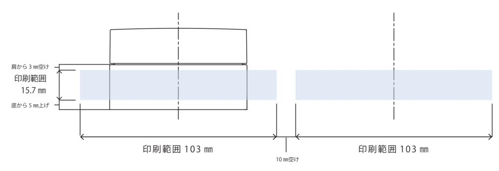
Cocon-80 スクリュー CAP 印刷範囲 ※本図面はシルク印刷における最大範囲を示していますが、
