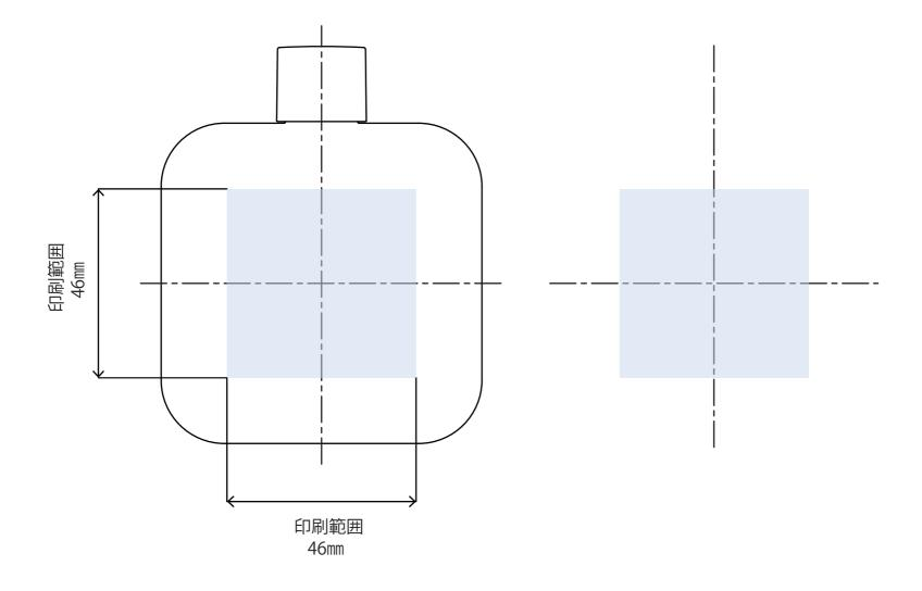
Bios-100(L) SSCAP 印刷範囲 ※本図面はシルク印刷における最大範囲を示していますが、
