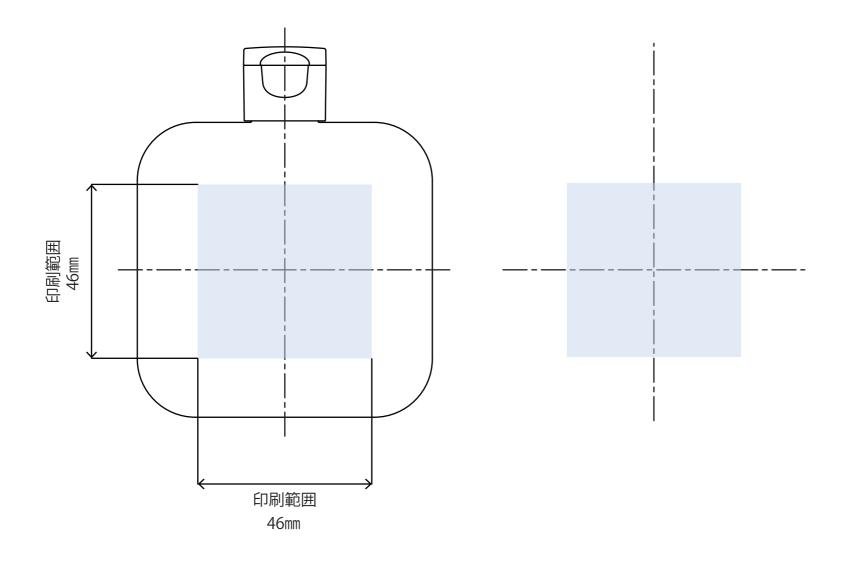
Bios-100(L) SS ヒンジ CAP 印刷範囲 ※本図面はシルク印刷における最大範囲を示していますが、
