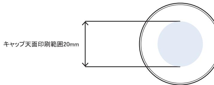
※ キャップ天面の天地左右両方向への最大範囲の印刷は不可
