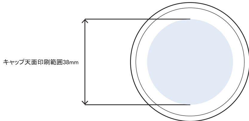
※ キャップ天面の天地左右 両方向への最大範囲の印刷は不可
